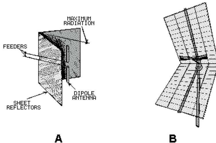
Figure 4-42.—Corner-reflector antennas.
