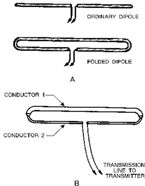
Figure 4-20.—Folded-dipole antennas.
